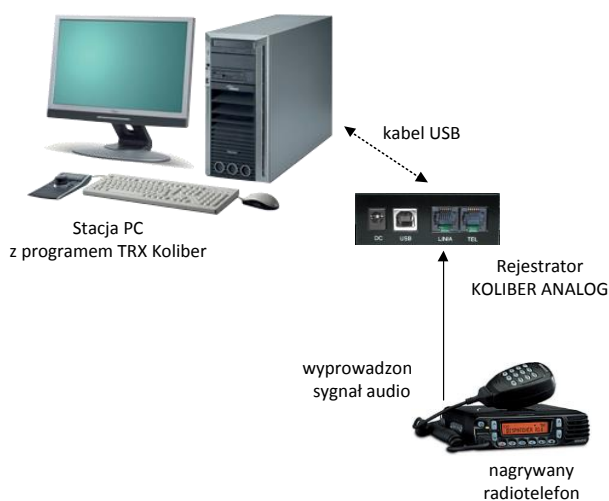
Podłączenie nagrywanego radiotelefonu do rejestratora KOLIBER ANALOG
